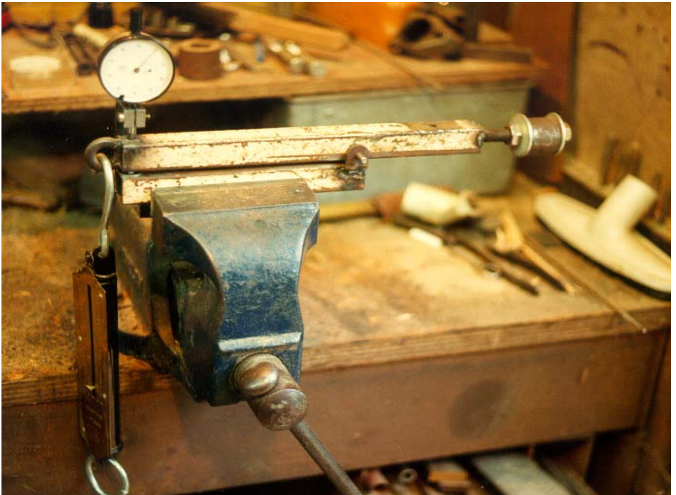
Testapparaat om de blijvende vervorming van kunststof kogels te bepalen
