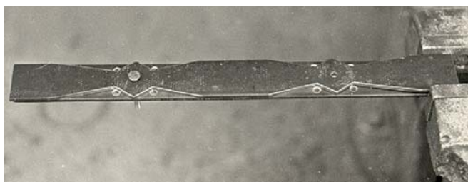
De gaten zijn met een boor afgetekend in met de boormal.
