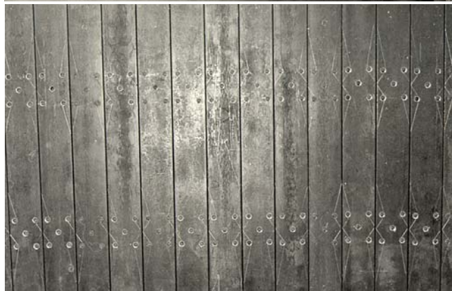
De schuine kanten worden afgetekend met een kraspen.
