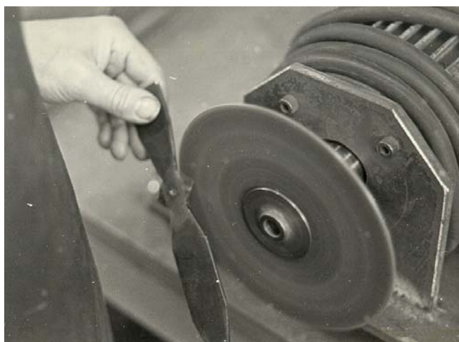
Met een schuurschijf worden de bramen verwijderd.
