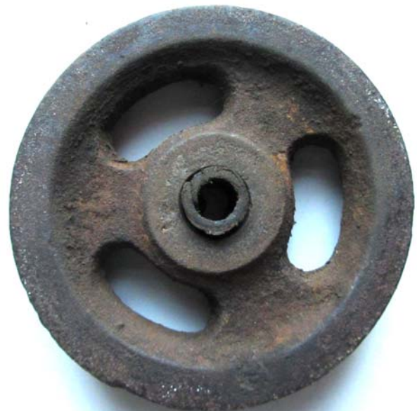
Draadschijf met vetlerenlager uit schildpadblok voor de zwaardloper.
