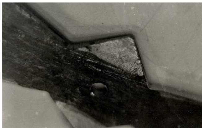
Met een schuurschijf worden de bramen verwijderd.
