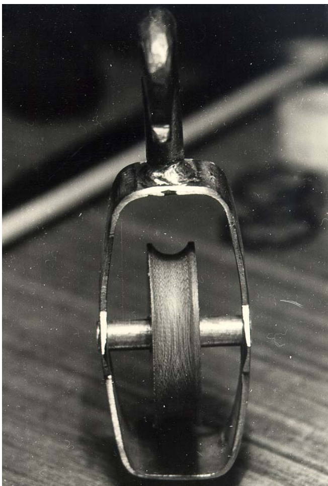
De haak kan gelast worden en het asgat pas geboord.
