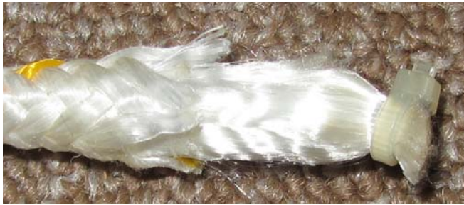
Constructie van een gevlochten schoot
