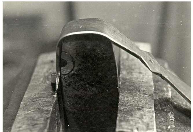
Wordt de stip om de mal gebogen.
