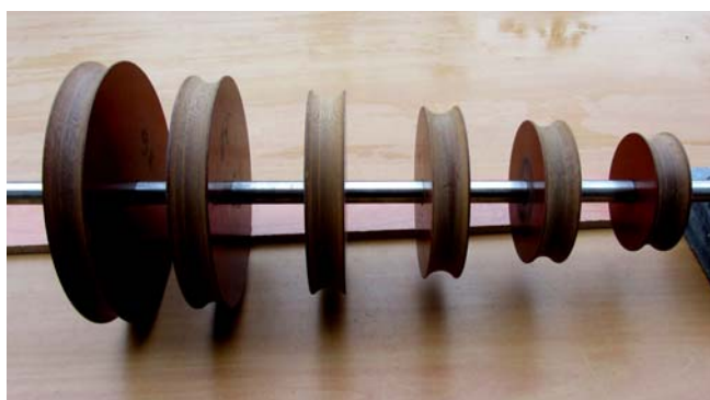
Testschijven ratio3 t/m 9 en testframe met schijf ratio 10
