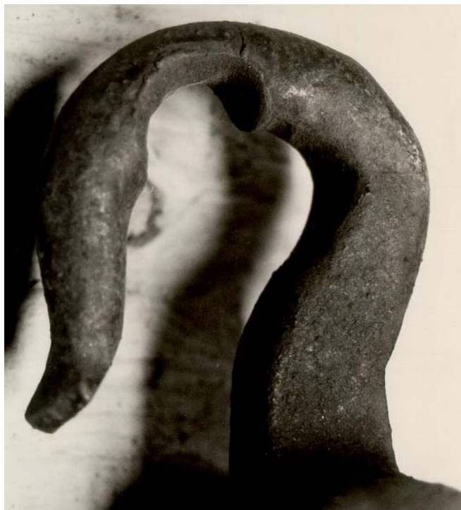
Deze haak is ernstig verzwakt. Oplassen is geen succes daar de structuur van het oude ijzer gaat veranderen en sneller zal breken. Uitgloeien na het oplassen kan dan een optie zijn maar slecht uitvoerbaar met een buitenbeslagblok.
