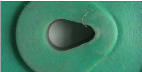
Thermoplasten vervormen onder belasting bij 10 kN
