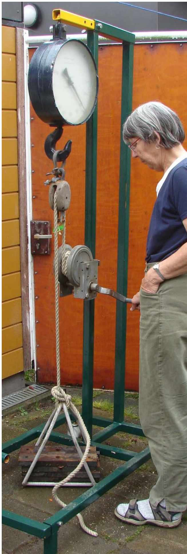
Deze opstelling gebruiken we tegenwoordig om het rendement van een blok te bepalen.
