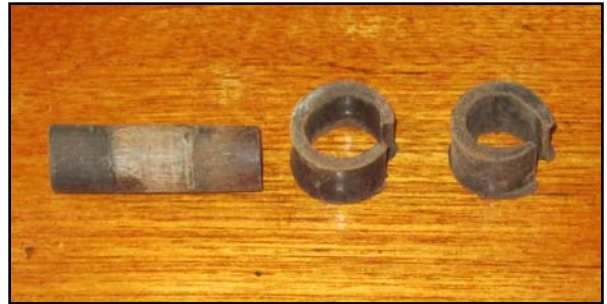
Vetleren lager met azijnhouten as
