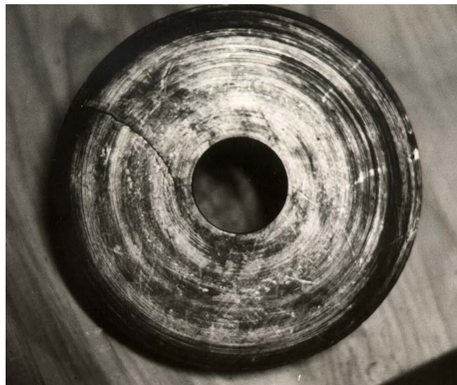
Deze schijf heeft in een blok met een scheve as gezeten. Daardoor is het asgat sterk uitgesleten. De schijf is ingesmeerd met grafiet om de wrijving te verminderen.
