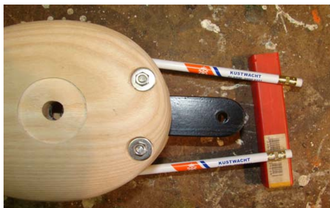
Deze "Marijke's potlodentest" geeft aan de de looper straks vrij loopt van de neuten.
