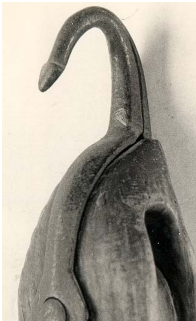
Dit blokje hoort in een museum thuis en niet aan boord van een schip.
