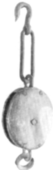
onderbaktagsblok friese tjalk 100 ton lange schalm i.v.m. zetboord
