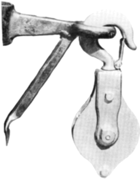
bij één vaste hanepoot hoort een horizontaal oog zodat het blok de giek kan volgen
