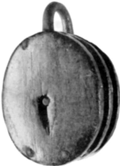
bovenbaktagsblok friese tjalk 100 ton 16 mm touw schijf 160ø
