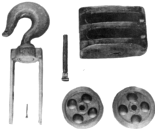
marineblok van goede constructie-zware haak-as geborgd tegen meedraaien en tegen uitvallen-relatief grote bronzen schijven.
