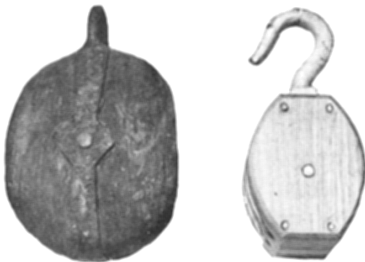
marineblok van goede constructie-zware haak-as geborgd tegen meedraaien en tegen uitvallen-relatief grote bronzen schijven.
