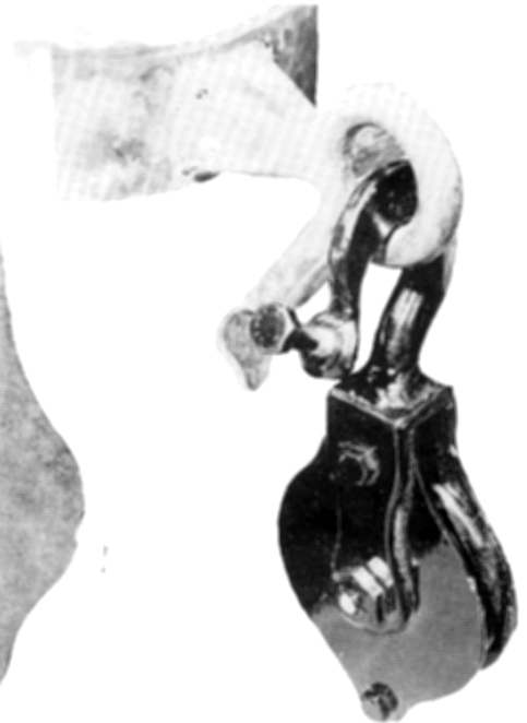
bij een vertikaal oog de haak „Bek over de nagel“. Kan alleen als het zeil een kleine beweging maakt b.v. bij een fok
