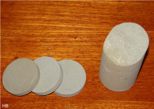
De schijfjes worden met een diamantboor uit de steen gehaald en later in plakjes gezaagd en geslepen
