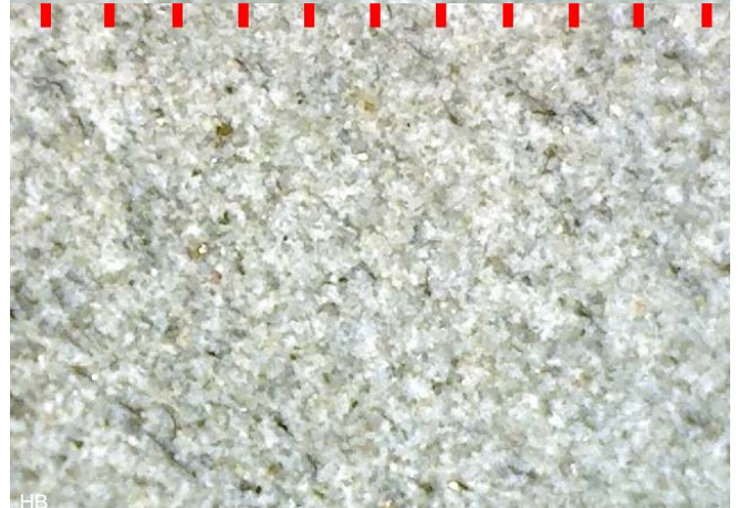
Micro 200x schaalverdeling 0,5 mm. De bovenste is van een puck en de onderste van een fijne banksteen.
