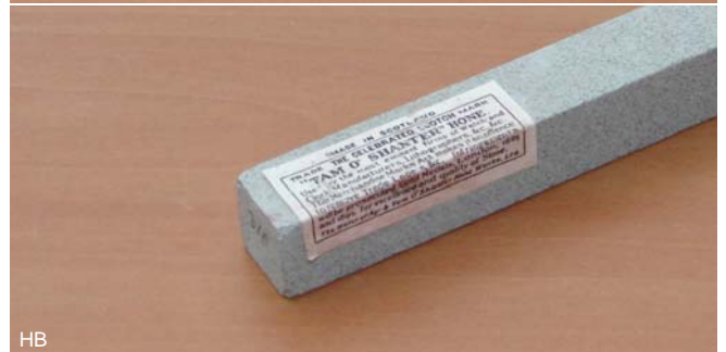
Er werden diverse vormstenen speciaal gemaakt om bv microtoommessen te slijpen, slijpstenen voor gutsen en speciale vormstenen voor goudsmiden.
