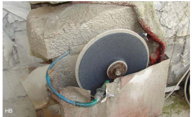
Een langzaam draaiende SiC schijf met waterkoeling voor het vlaklijpen en het in vorm brengen van de zeisstenen.
