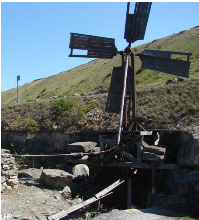
Windgedreven pomp om droge voeten te houden.
