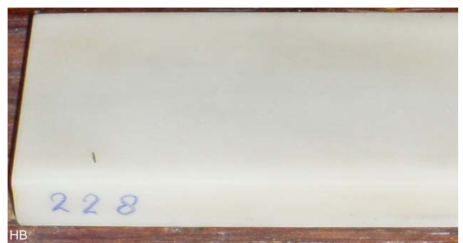
In deze wasachtige translucente Arkansas (3 -5 \mu ) is geen gelaagdheid of korrel te herkennen.
