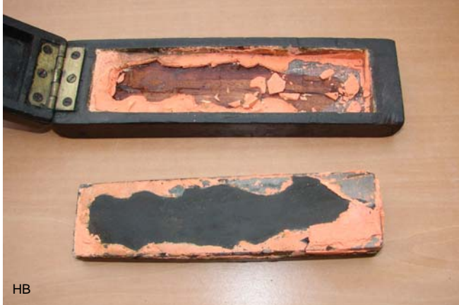
Bij deze wetsteendoos zijn er 2 overslagsluitingen aangebracht waardoor het deksel gemakkelijk afgenomen kan worden.
