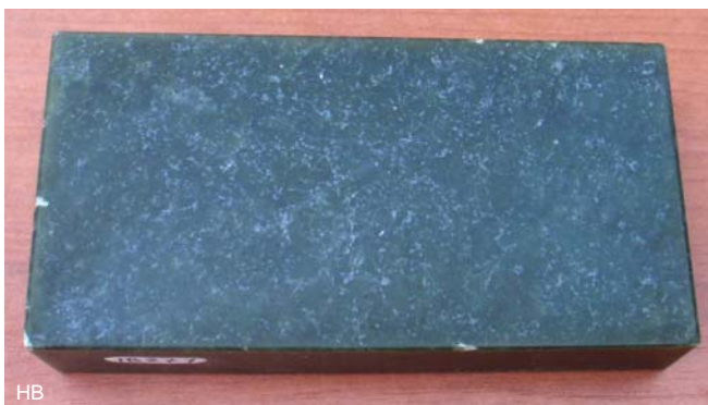
Nephrite een Na-rijk pyroxene (jadeite) wetsteen met een zeer fijne korrel. Nephrite is sterker (200 MN/m 2 ) dan jadeite (100 MN/m 2 ). Afkomstig uit Brits Columbia. Er zijn daar 15 groeves bekend. Het is de beste kwaliteit die beschikbaar is in de wereld.
