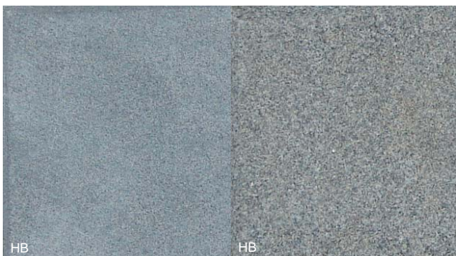
2 kwarts zandstenen Due Medaglia uit Pradalunga Italië. Links de fijne F500-600 (13 \mu ) en rechts F 280-320 (35 \mu ).
