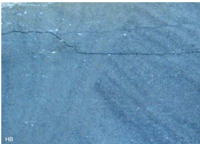
Na de verlijming. De verlijming heeft geen effect op het slijpen of de snede.
