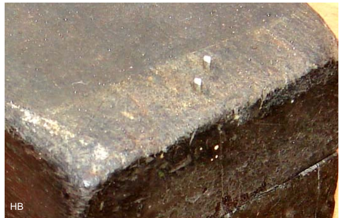
Bij deze wetsteendoos zijn er 2 overslagsluitingen aangebracht waardoor het deksel gemakkelijk afgenomen kan worden.
