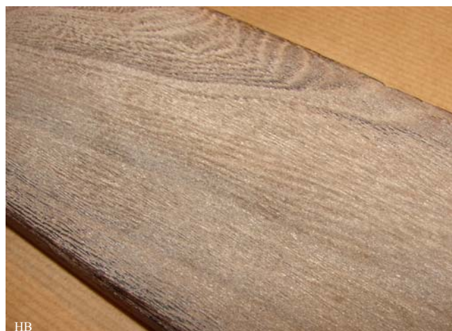
Bij deze macro opname is te zien dat de slijpkorrels in het oppervlak van het hout zijn gedrongen.
