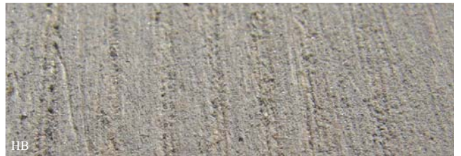
Deeltjes van het zilverzand zijn in het oppervlak gedrongen. Ook als het zand verwijderd is kan er door de gebroken korrels nog met een fijner resultaat na geslepen worden.
