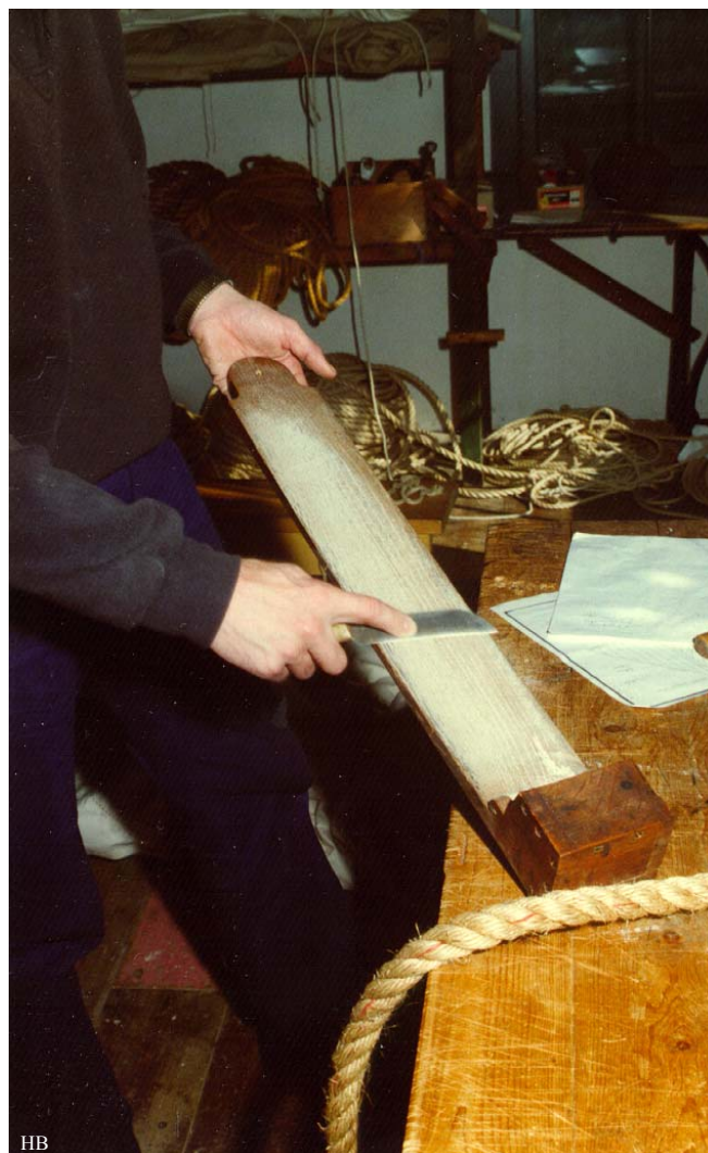
De zeilmaker van het Zuiderzee museum slijpt zijn mes op een slijplank met zandbak.
