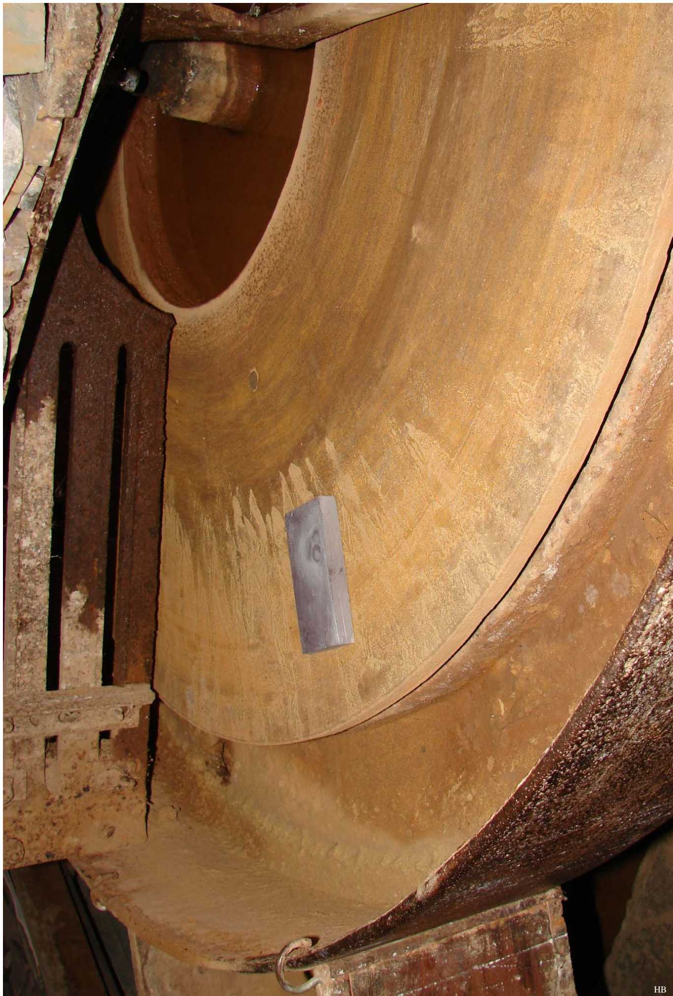
Het vlak maken van weistenen gebeurde vroeger op een gietijzeren schijf met zand en water. Men noemde het vlakslippen maar de techniek is 'Läppen'. Tegenwoordig worden de stenen vlakgeslepen op een diamantschijf.
