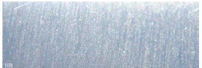
De korrels geven een grof resultaat. Door het gebruikte zand te verzamelen zal het beeld steeds fijner worden.
