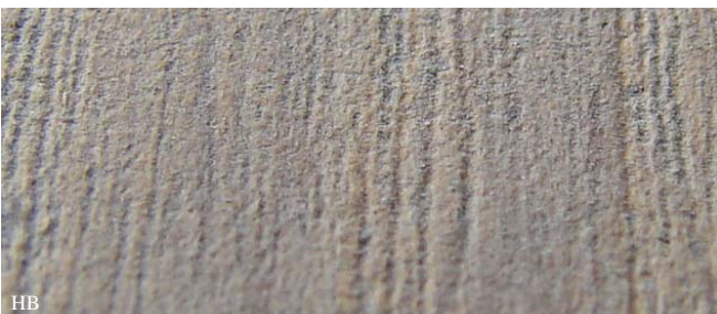
HB Hele fijne deeltjes biksteen zitten in de poriën van het hout
