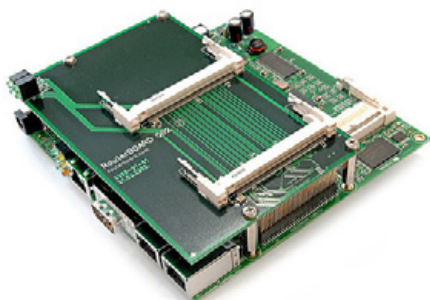
RB502: Two extra Mini PCI slots
