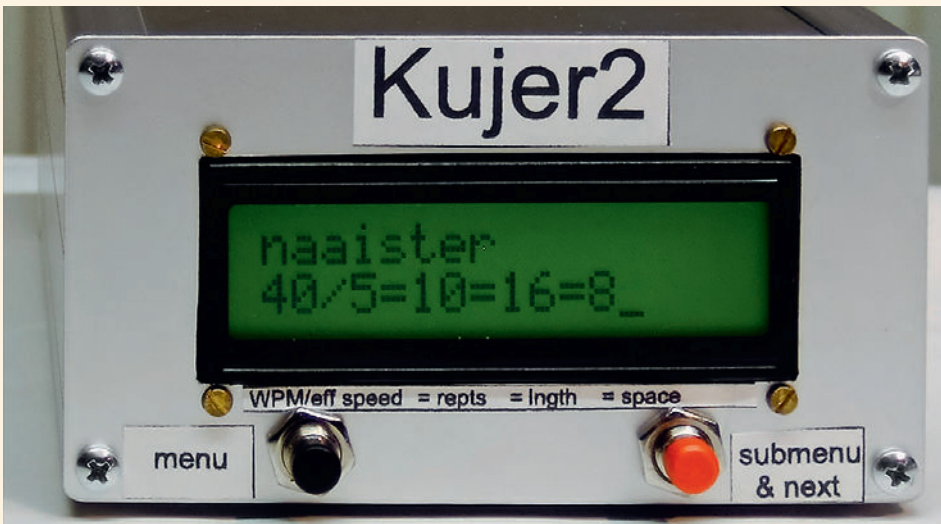
Foto 2 Voorkant Kujer2 met voorbeeld van instelling op display
