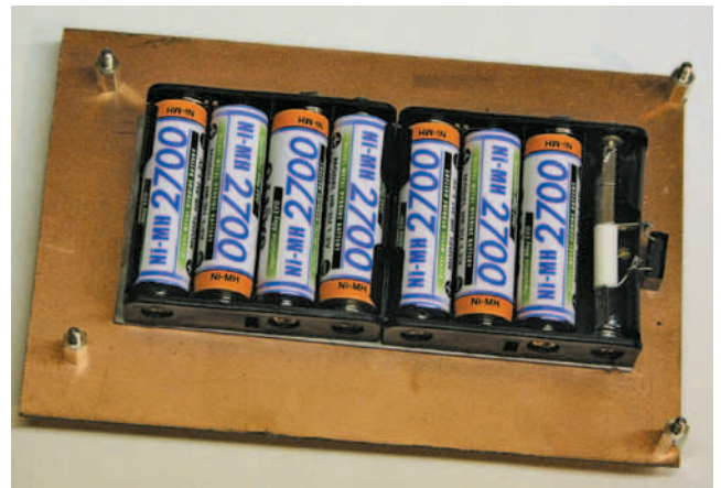
Foto 6. De noodbatterijen. Let op de zekering. Photo 6. La batterie de secours. Remarquez le fusible.
