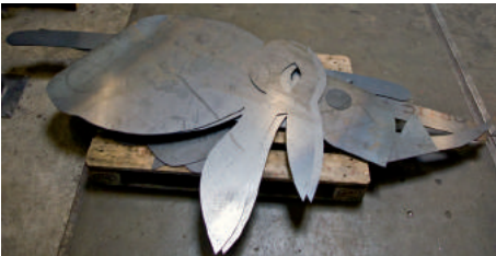
De vormen uit 4 en 6 mm dik cortenstaal zijn uitgesneden.
