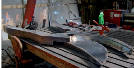
De schaar is rondom gelast maar nog niet afgewerkt.
