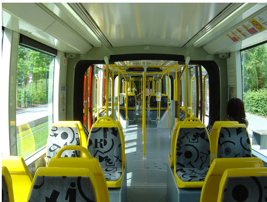
Afbeelding 13: een tram met een breedte van 2,65 meter heeft een opvallend ruim en comfortabel interieur, zoals deze foto in een tram Mulhouse bewijst. Foto TransTec.
