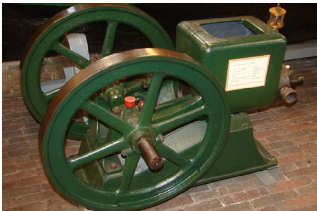
Motor met open verdampingskoeling van het merk Witte.
