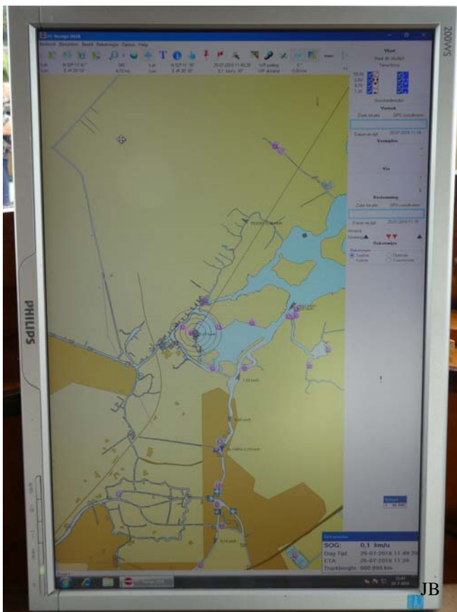
De ECDIS aan boord van de Terra Nova
