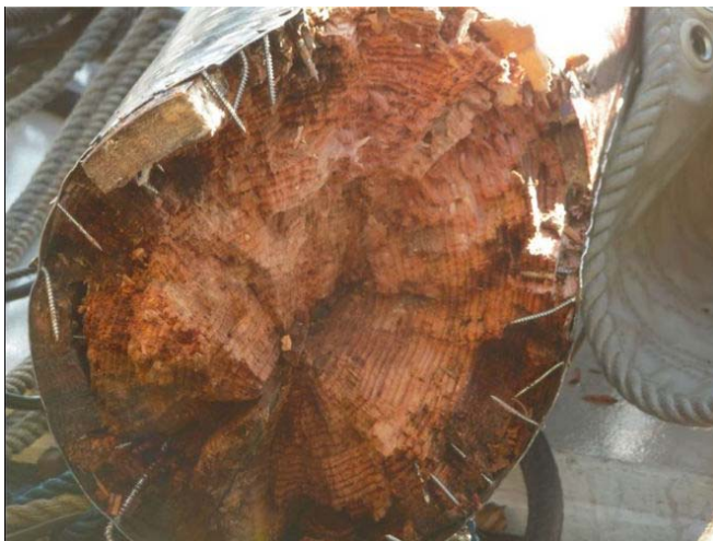
Afgebroken rotte mast met gaffelplaat. Foto OVV rapport.
