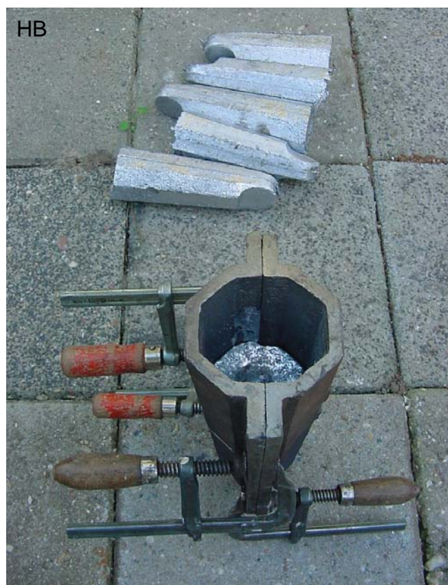
Henk Bos heeft de dieploden zelf gegoten in een eigen mal
