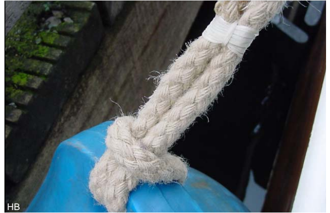
Met een oog in het ophanglijntje wordt de kracht over een groter oppervlak verdeeld.
