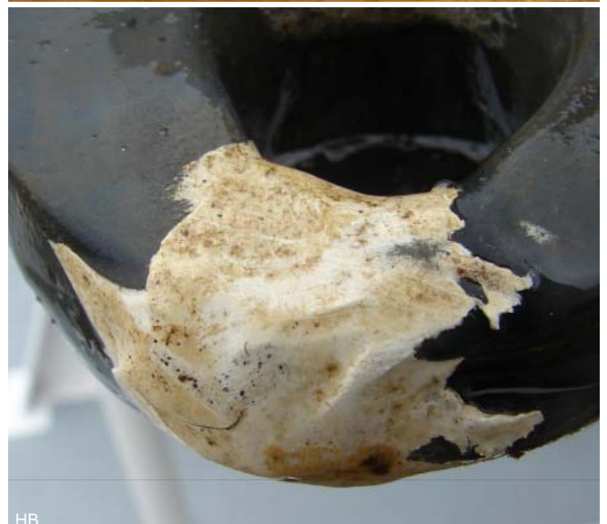
Deze met Proflex gerepareerde fender is al weer jaren in gebruik.
