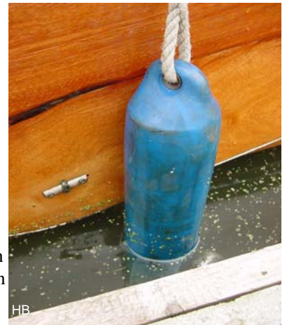
Met een oog in het ophanglijntje wordt de kracht over een groter oppervlak verdeeld.
