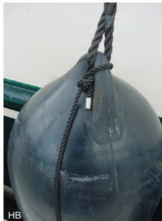
Met een permanent extra lijntje is de fender eenvoudig en snel horizontaal te hangen.
