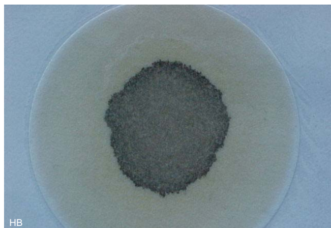
Bij dit monster is de buitenste ring sterk uitgevloeid. Het is of een hele dunne olie, of een zeer warme dag tijdens het testen of de olie bevat brandstof bv. van een slechte verstuiver. Het wordt tijd om een vakman te raadplegen!
