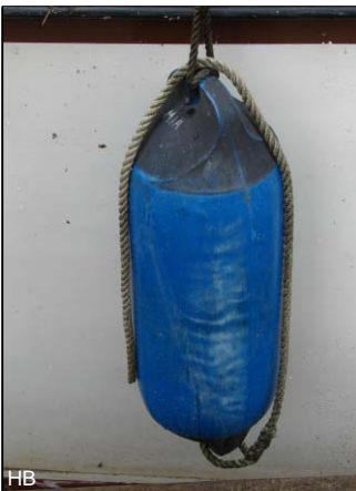
Met een permanent extra lijntje is de fender eenvoudig en snel horizontaal te hangen.
