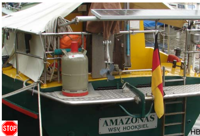
Je ziet het vaak maar veilig is het niet. Bij lekkage kan het zo naar binnen lopen.
