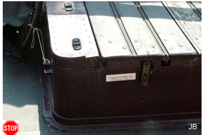
Lege flessen moeten rechtop staan en vastgezet zijn. De hoogte in deze herft is niet genoeg om lege flessen ordentelijk te bergen.
