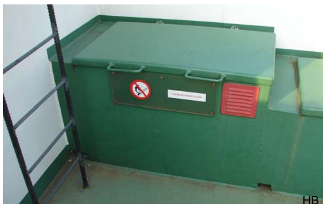
Een bun is een bergplaats voor een gasfles onder het dek of in de kuip.
