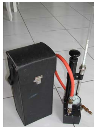
Een watermanometer in gebruik bij Sailing Expertise. Links: Wassermanometer FESA 13
