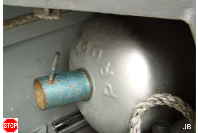
Lege flessen moeten rechtop staan en vastgezet zijn. De hoogte is niet genoeg om lege flessen ordentelijk te bergen.
