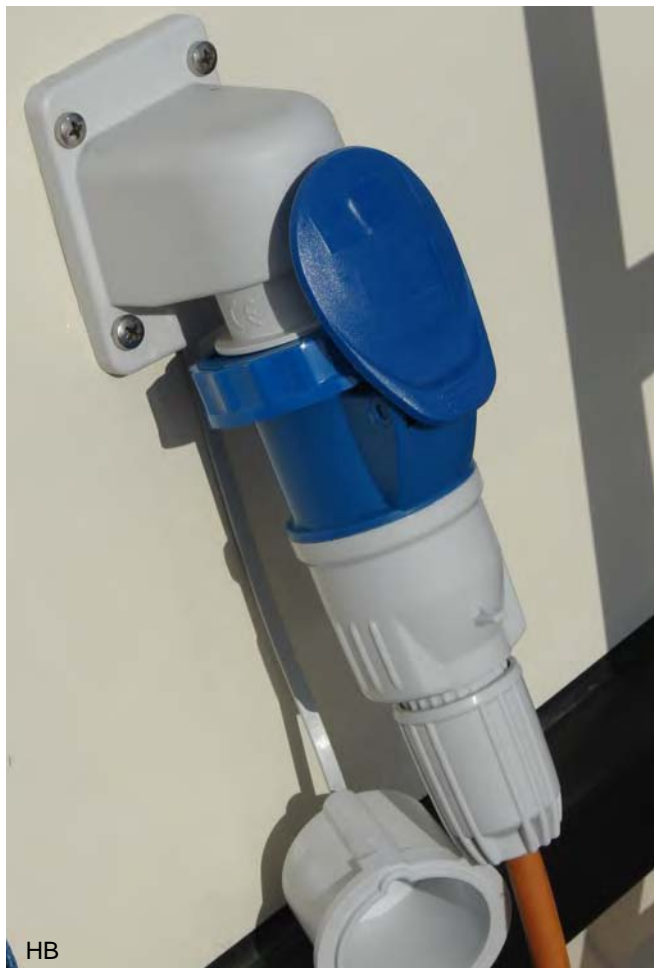
HB Een spatwaterdichte 'Wandgerätestecker' op de spiegel van een jacht. Het gedeelte op de spiegel is een mannetje waar de contra stekker op past.
