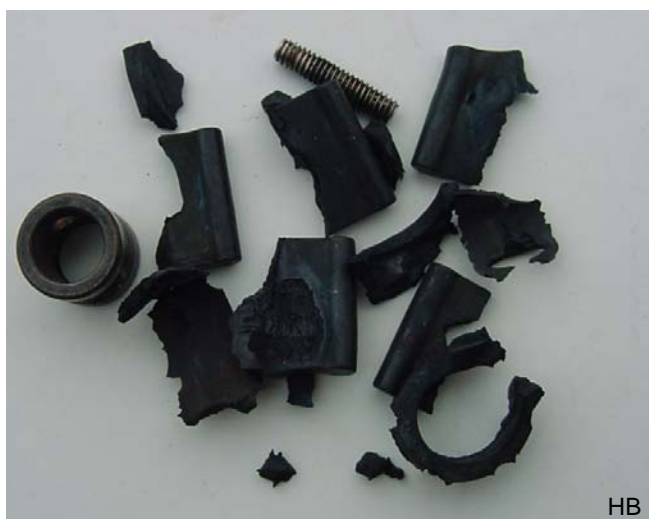
Deze impeller heeft 600 uur dienst gedaan zonder gecontroleerd te zijn. De onderdelen zijn verzameld uit de warmtewisselaar.
