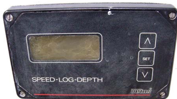
UV is funest geweest. Het apparaat is niet weerbestendig.
