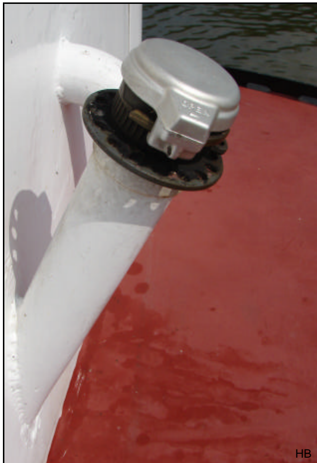
Bij deze aansluiting is de onderkant van de oude BP dop blijven zitten.
