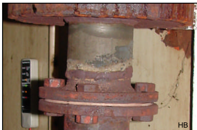
Bij deze door de schipper zelf gebouwde uitlaat zijn flenzen toegepast met een klingerit pakking er tussen.
