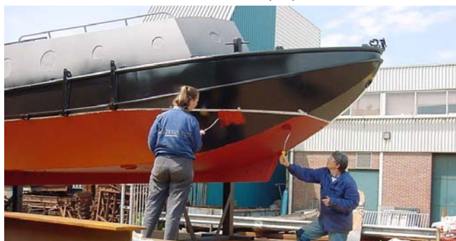
Op 14 juni 2003 krijgt Margeja na de zwarte tweecomponentencoating een nieuwe waterlijn door Janneke en Ge Bos-Thoma (EC)
