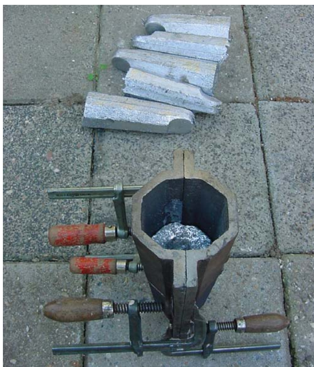
Henk had een eigen voorraad lood, een smeltpan en een gietpan. Hier worden dieploden gegoten, 5 nov 2005 (EC)
