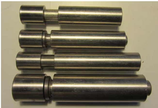
Met deze op de draaibank op maat gemaakte paspennen worden lagere in schijven van scheepsblokken geperst (EC)
