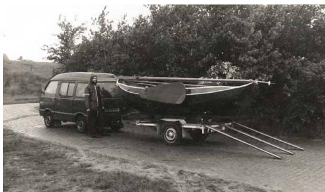
De Hollandse Boot heeft een eigen botentrailer die op de aanhanger gereden kan worden (EC)
