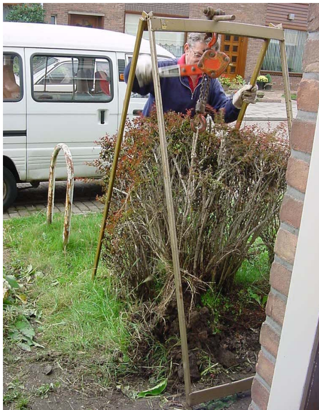
Hoe haal je een prikstruik eruit (Berberis)? Met een tirfor en een hijsstelling, 11 september 2003 (EC)
