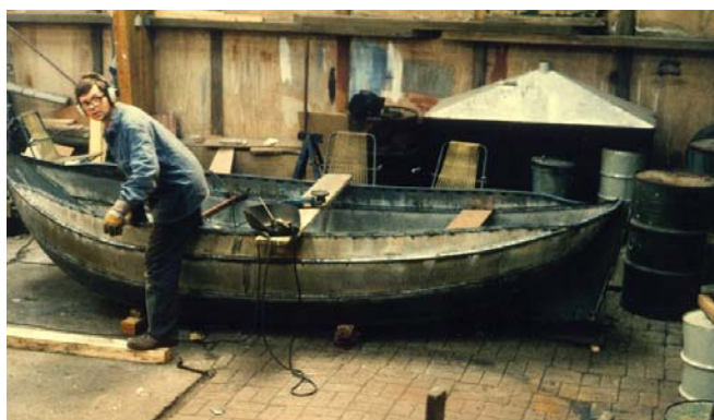
De laatste hand wordt gelegd aan het aflassen van de Hollandse Boot in de botenloods in Uitgeest (EC)
