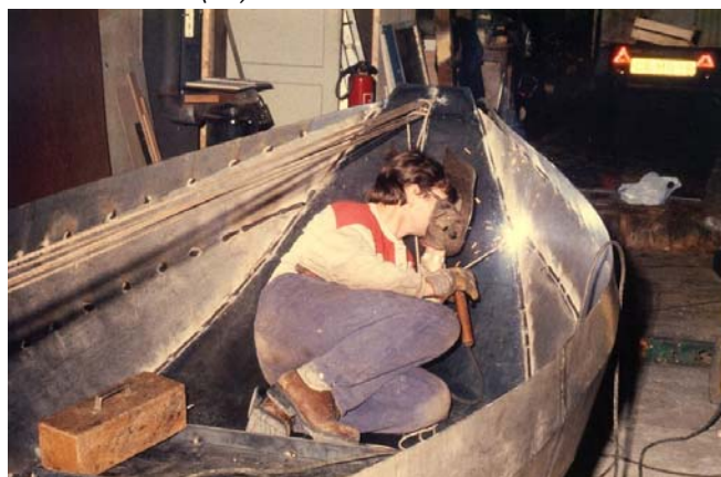
Henk Bos aan het aflassen aan de Hollandse Boot (ontwerp Henk Bos), pinksterweekend 1986, Krommenie. De lengte van de boot wordt na het hechten bepaald door een takel te zetten op beide uiteinden en te trekken. De Hollandse Boot mocht maximaal 4 meter lang zijn in verband met de lengte van de garage (stalling) (EC)
