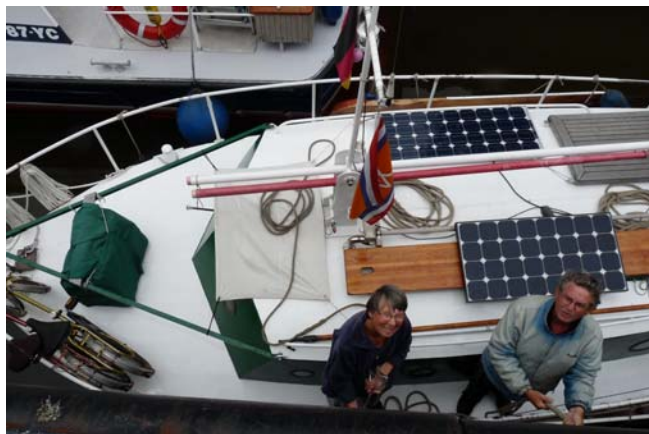
De 3 zonnecellen (achterop zit nog een kleine) zorgen ervoor dat walstroom nauwelijks meer nodig is, 2009 (EC)
