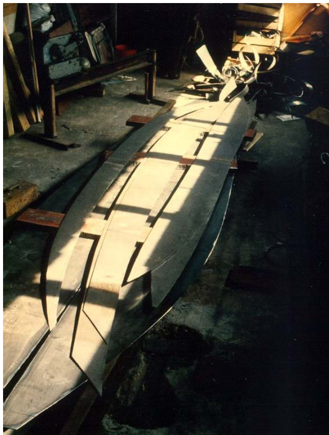
De staalplaten gesneden en geknipt, die nodig zijn voor de bouw van de Hollandse Boot, Pinksteren 1985 (EC)
