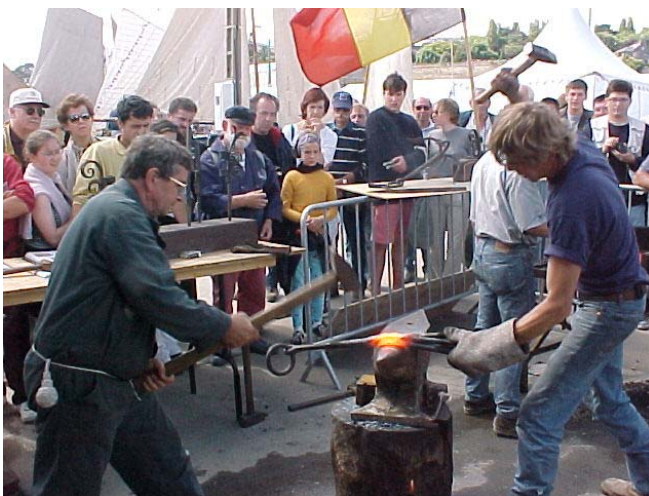
In juli 2000 ging de hele familie met 3 auto's naar Brest in Frankrijk om daar het smeden en de blokmakerij te laten zien. Ook de Hollandse Boot ging mee om een typisch Nederlands scheepstype te laten zien. Henk smeedt hier met een Franse smid de bladen van een dreganker aan elkaar met een speciale techniek: wellen (EC)
