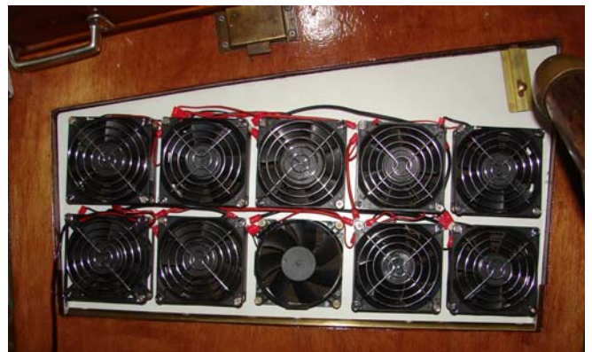
De definitieve oplossing met 10 oude ventilatoren van oude computers op 12 Volt. Heerlijk koel binnen! (EC)
