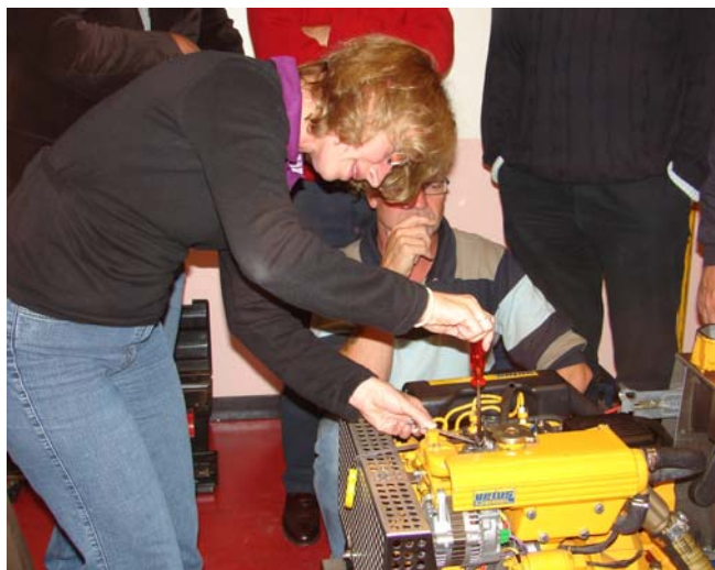
De kleppen van de instructiemotor zijn honderden keren afgesteld. Meestal liet Henk dat dames doen, oktober 2009 (EC)
