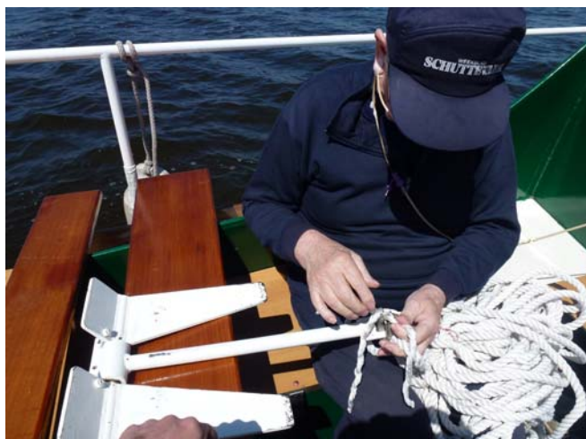
Henk legt met behulp van een oogsplits de ankerlijn vast aan het achteranker, aan boord Margeja 18 mei 2014 (EC)
