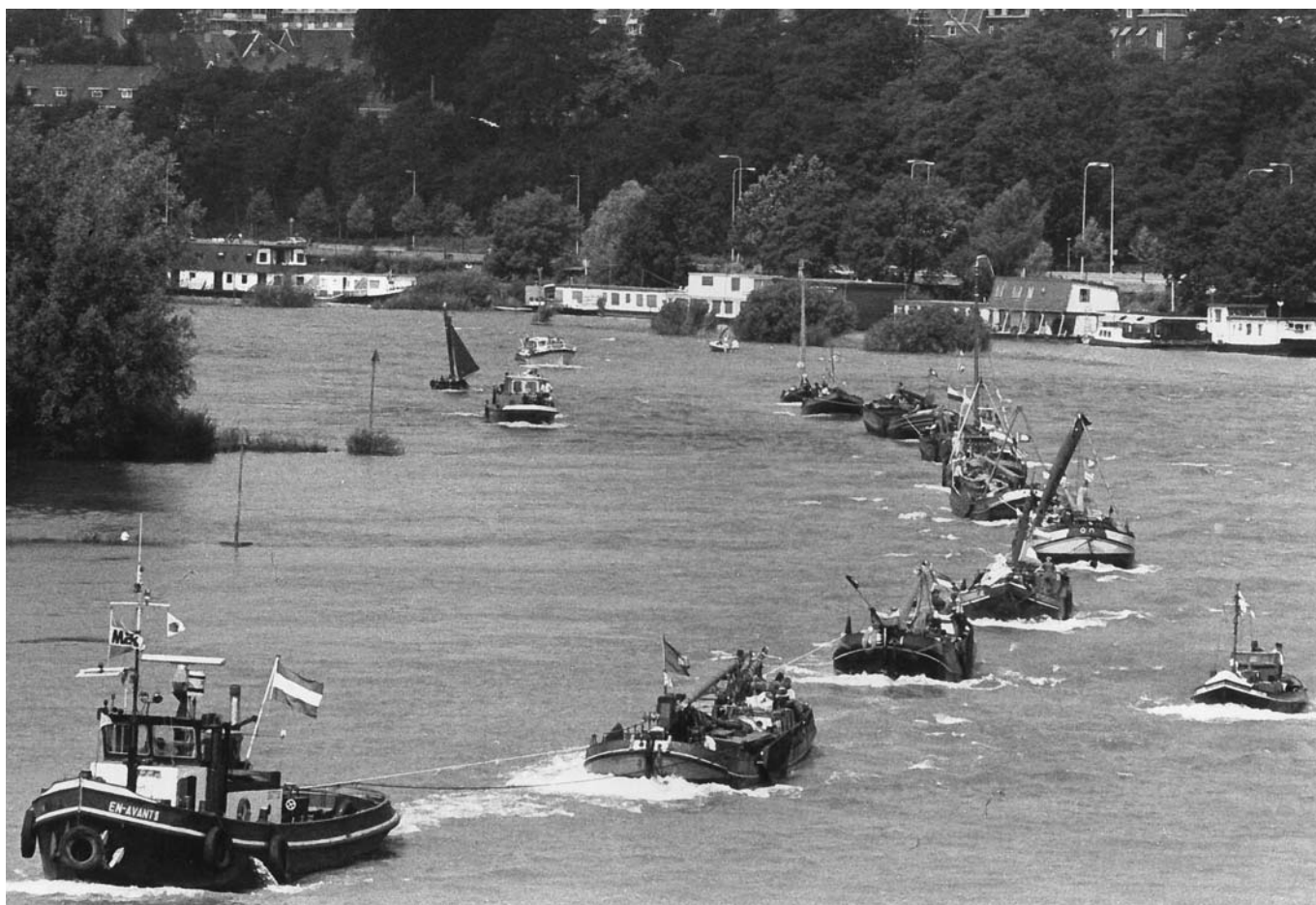
Krantenfoto met daarop een sleep om de oude sleeptochten van voorheen weer eens over te doen en te laten zien aan het publiek. 10 Schepen op een rij, de Welvaart hangt direct achter de sleepboot en krijgt het zwaar te verduren. De voor- en achterbolder worden bijna uit het schip getrokken. Door een staaldraad en tirfor te spannen tussen beide bolders wordt het schip nog bij elkaar gehouden, zondag 12 juli 1987 (EC)
