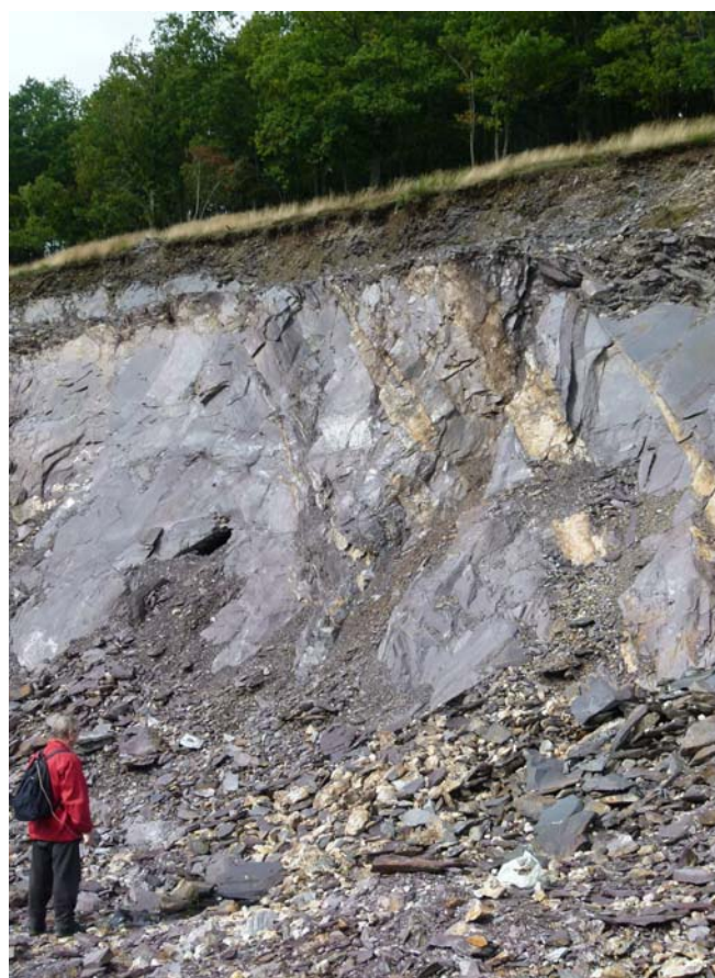
Tijdens het Coticule weekend in de Ardennen werd een gezamenlijk bezoek aan de dagbouw mijn gebracht waar de Belgische brokken vandaan komen. De gele strepen zijn goed zichtbaar in de rots. De zwarte driehoekige vlek in de wand is een oude mijnbouwgang, september 2013 (EC)
