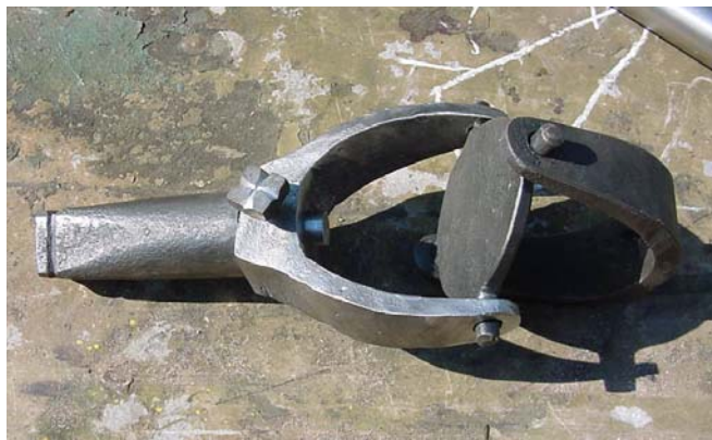
Een volledig door Henk Bos gesmede cardanische koppeling voor het torenuurwerk van het Groene Kerkje te Lambertschaag, 9 april 2003 (EC)
