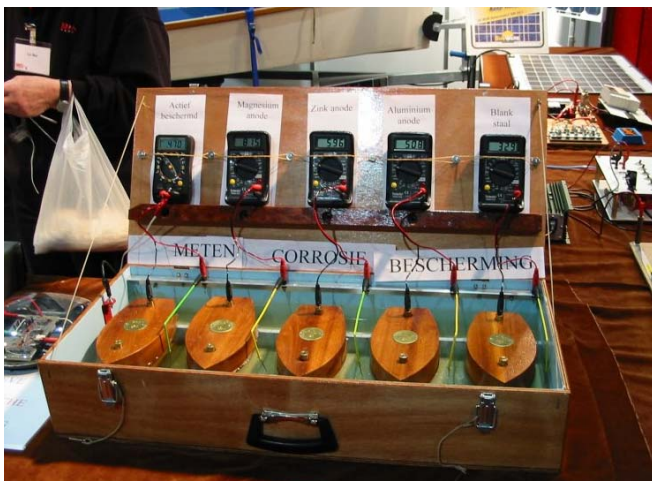
De bak met proefbootjes en anodes op de HCC dagen van 2003. Met metingen worden verschillende stromen zichtbaar. Ge Bos (links) staat te breien op de stand (EC)
