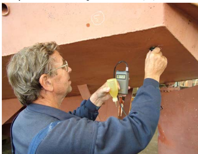
Het meten van de staaldikte van een motorjacht dat op het droge ligt, 17 september 2005 (EC)
