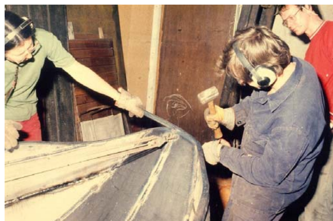
Henk Bos timmert een hoekstaal om de rand van de Hollandse Boot. Ge Bos-Thoma houdt vast en onder spanning zodat er geen ruimte ontstaat, Wim de Ruijter kijkt toe, pinksterweekend 1986, Krommenie (EC)
