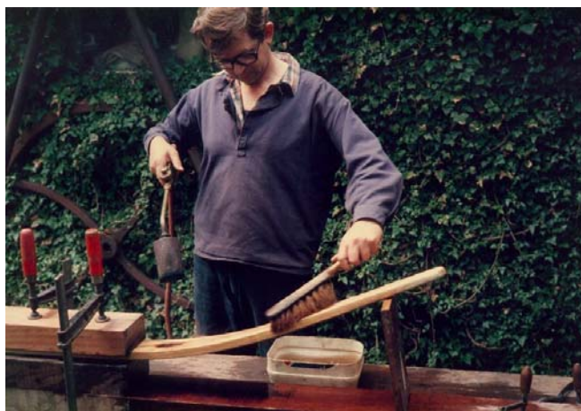
Het branden en nat maken van het hout van de helmstok van de Hollandse Boot zodat deze krom gaat staan en blijft staan, juni 1986 (EC)
