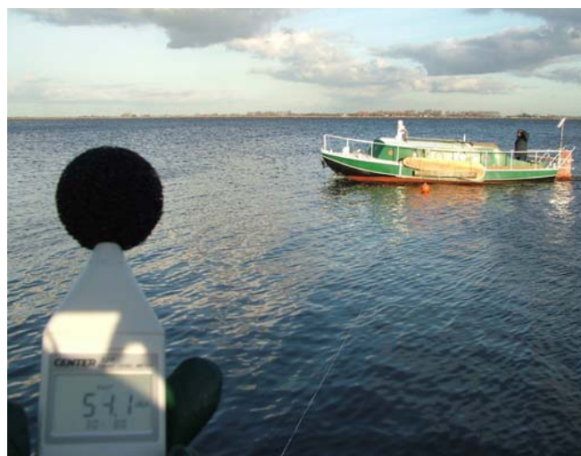
Het meten van het geluid op een afstand van 25 meter terwijl Margeja voorbij vaart, 10 december 2006 (EC)
