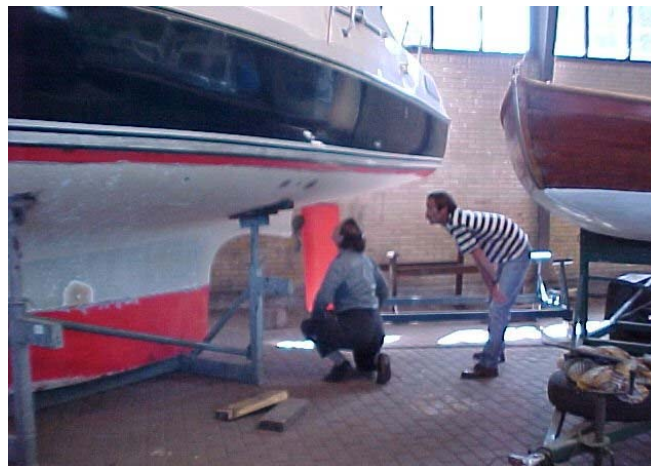
Tussentijdse keuring van het drogen van het polyester jacht Safaja van Willem Schermer (Hoogovenscollega van Henk), nadat het is geschild omdat het osmose had, 2000 (EC)
