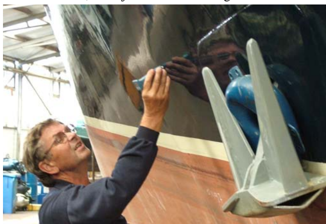
Het meten van de verfdikelaag. Een dikke verflaag op een stalen schip, moet verrekend worden met de staaldikte (EC)
