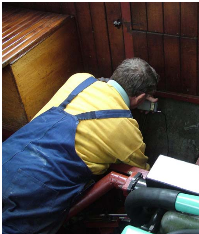
Het meten van de staaldikte van de machinekamer van een motorjacht dat in het water ligt, 3 oktober 2004 (EC)
