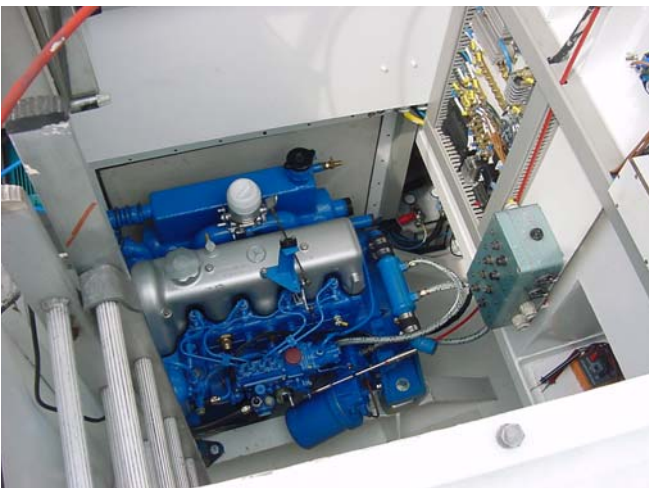
De Mercedes motor is april 2004 gereviseerd en opnieuw ingebouwd. De machinekamer is meteen aangepakt (EC)
