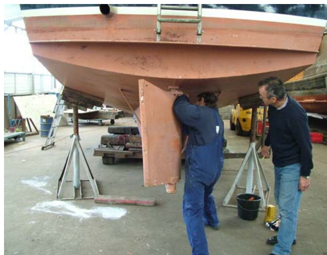
Het meten van de speling van het roer en de schroef, rechts de potentiële koper Geert Flobbe, 17 september 2005 (EC)
