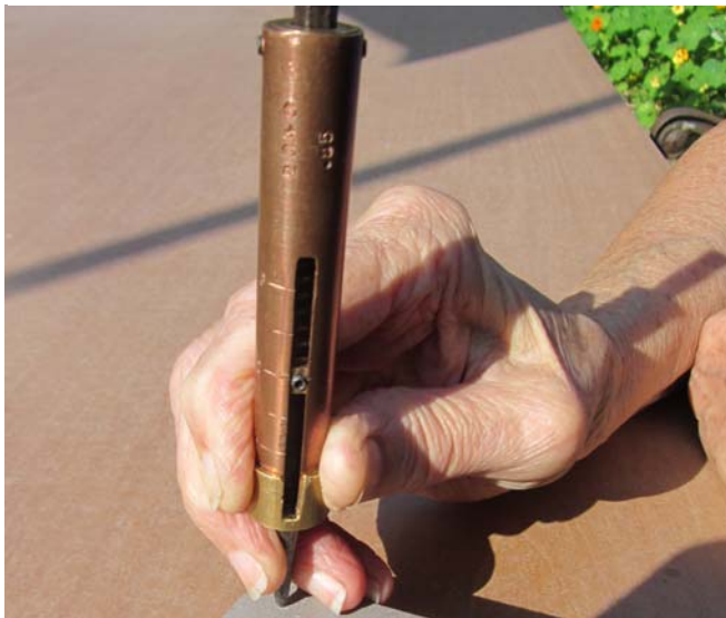
De zelf gemaakte sclerometer oktober 2014 (EC)
