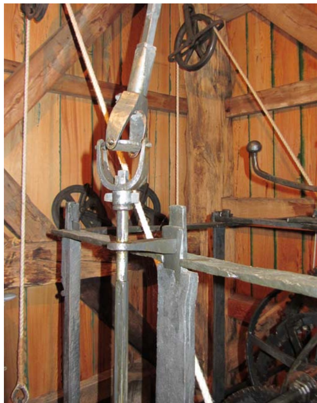
De door Henk gesmede cardanische koppeling in functie, in het Groene Kerkje te Lambertschaag, mei 2013 (EC)
