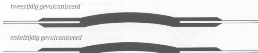
19. Doorsneden van ge vulcaniseerd expansieband. Goed expansieband is tweezijdig ge vulcaniseerd.
