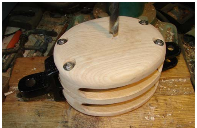
De asgat wordt geboord met een boor die een halve mm te klein is. Voorzichtig en kijken of het frame er goed inzit.
