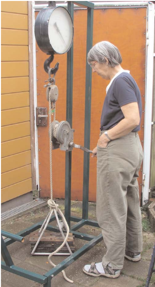
De opstelling voor het meten. Het apparaat is gemaakt van een fitness toestel voor de borstspieren. De gewichten zijn 5 kg terwijl de grijze beugel ook 5 kg weegt. Daardoor is de last per 5 kg te verstellen en aan te passen aan het blok.
