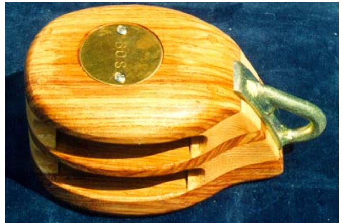
Ook dit klauwvalblokje is op de zelfde manier gemaakt. In plaats van boutjes zijn hier deuvels en epoxy gebruikt.
