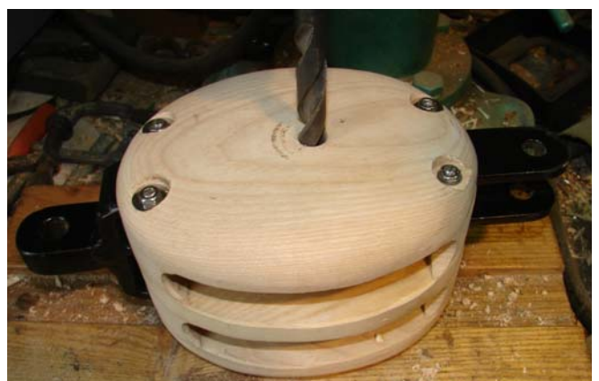
Zit alles goed dan wordt ook het gat in de dam en de andere wang geboord..
