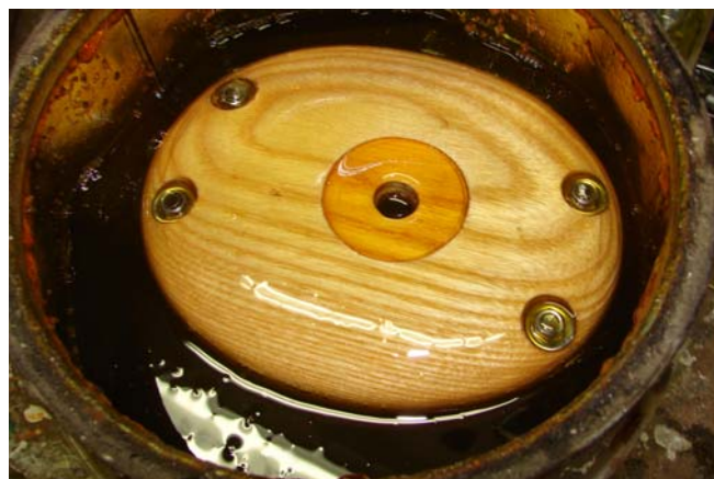
Een halfuur zwemmen in een mengsel van Lijnolie, Benarolie, Blankelak en Thinner verhouding 1:1:1:1.
