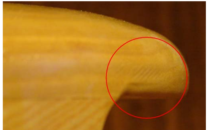
Voor een vloeiende bolle lijn moet de frees aangepast worden.
