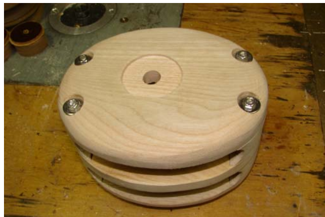
Het huis is klaar om geïmpregneerd te worden.
