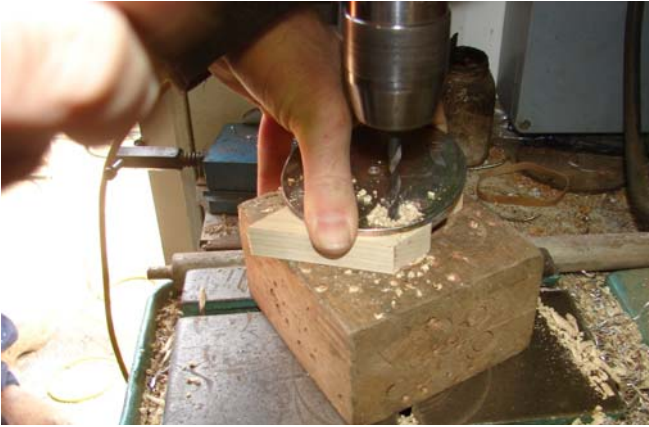
De gaten worden met de mal geboord.
