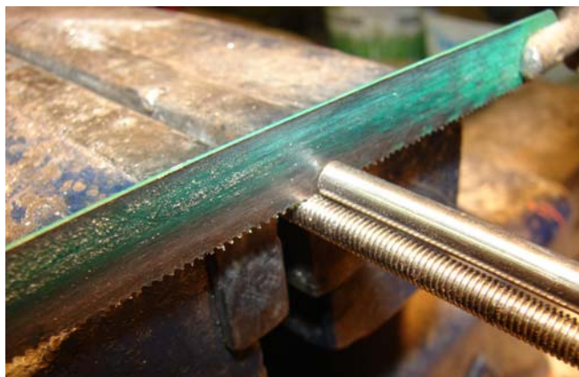
De zaag gelijk houden met het eind van het hulpstuk.
