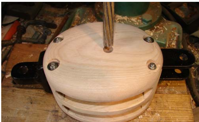
Na het boren wordt het asgat op maat geruimd. Let op! De frees is iets taps aan het eind. Door niet helemaal door te ruimen zit de as straks precies klem en draait hij niet mee.
