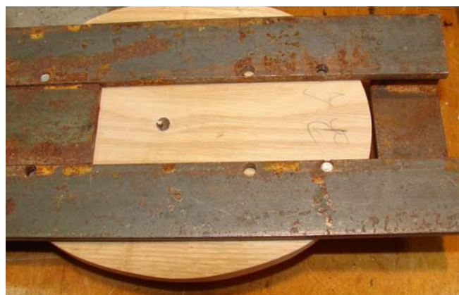
Frezen van de uitsparingen voor de stripjes.
