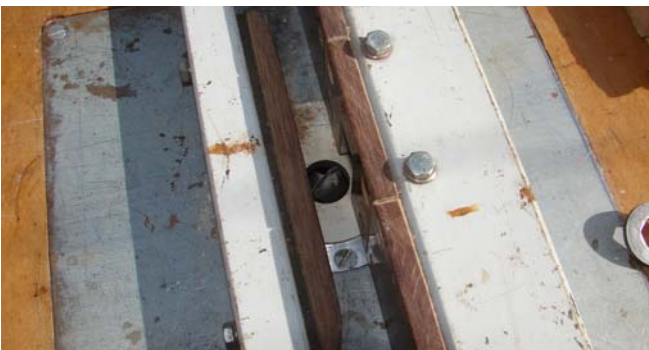
Hiermee wordt de holle keel wordt in de bovenklos gefreesd. De linker geleide is verend door celrubber.
