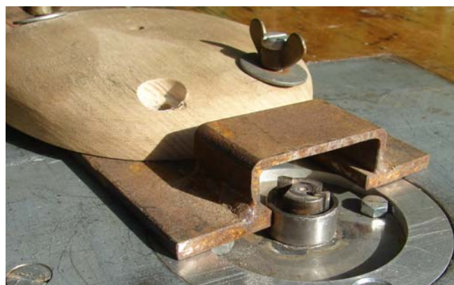
De diameter van de geleidebus is 4 mm groter dan de frees. De afstand tussen de stalen geleiders is framebreedte plus 4 mm. De combinatie hoort daarom bij de freesmal.
