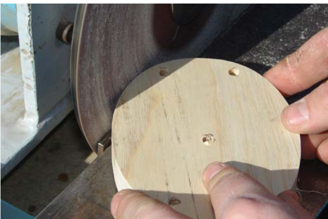
De schuurmal drukken we tegen de steun op de schuurtafel. Door de wang te draaien krijgen we de exacte vorm van de wang. Door de tafel af te stellen krijgen de wangen de juiste maat (potlood lijn).
