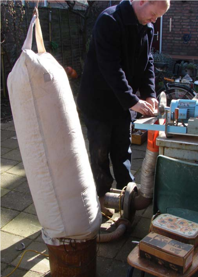
De stofvanger is gemaakt van een verfblik waar een tangentiële slangaansluiting is gemaakt. De blaaskant van de ventilator is daarop aangesloten. Het stof maakt daardoor een draaiende beweging in het blik en de stofzak. De zak is gemaakt van een oud laken.
