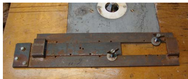
De lengte van de gefreesde uitsparing kan ingesteld worden door de middenstrip. Weggehaald krijgen we doorlopende uitsparing voor een hondsvot. De lengte van de mal wordt bepaald door de grootte van een vioolblok. Let op de fijninstelling.
