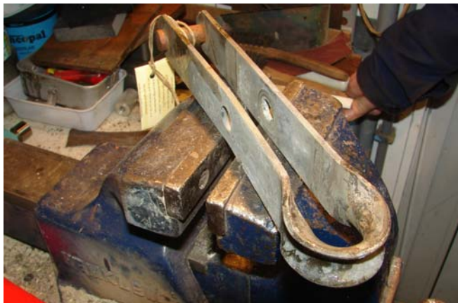
Dit frame is verbogen
