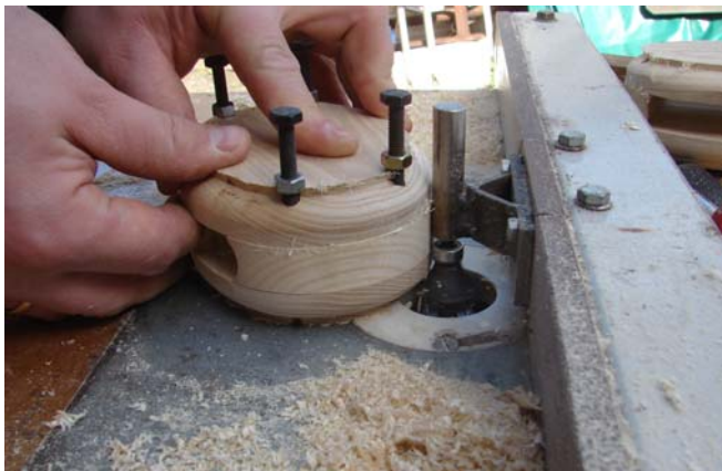
De onderdelen zijn tijdelijk in elkaar gezet op een dusdanige manier dat de bouten niet in de frees kunnen komen. Kijk uit voor je vingers! Er blijft een klein randje staan.
