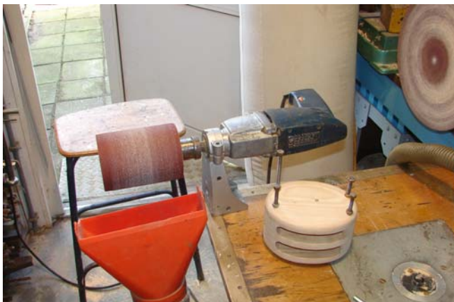
De opstelling voor het fijn naschuren.
