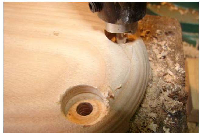
De potgaten voor de boutjes zijn geboord en het huis is klaar voor de afwerking, conservering en montage.
