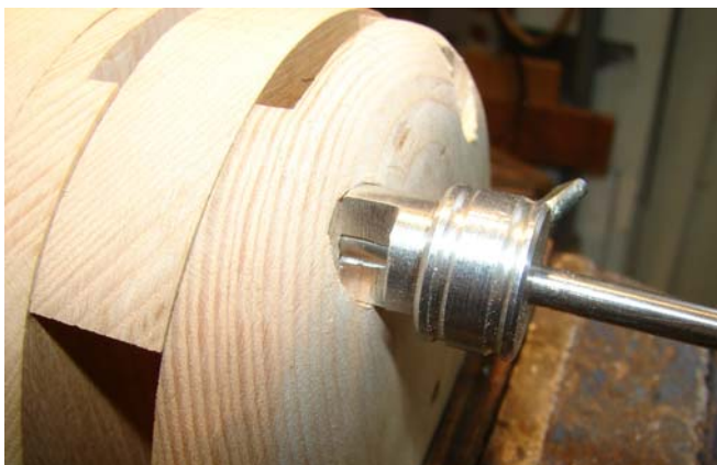
De lengte van het draadend wordt gemeten met de dieptemaat. Zie ook pagina 15.
