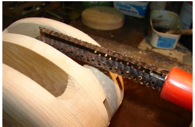
De neuten worden tot aan het lijntje gevijld. Let op! De Surform houtrasp trekkend monteren.
