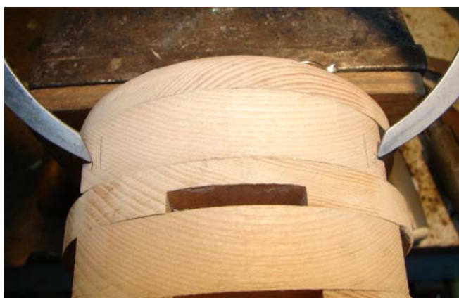
De spoordiameter wordt afgetekend op de klossen..
