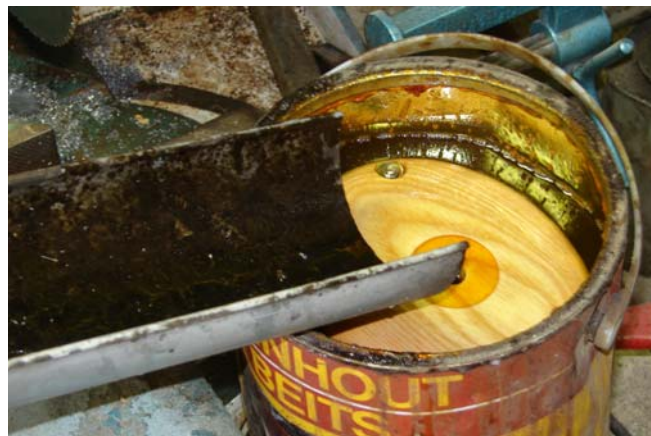
De gedompelde huizen hangen aan een haak boven een regengoot die eindigt boven de voorraadbus.
