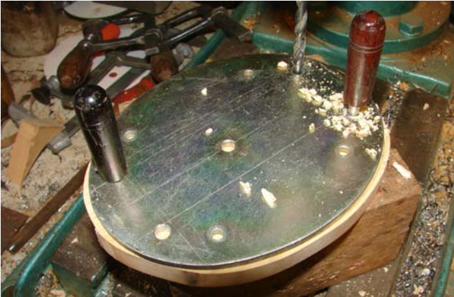
Op de zelfde manier worden de boutgaten in de wangen aangebracht.
