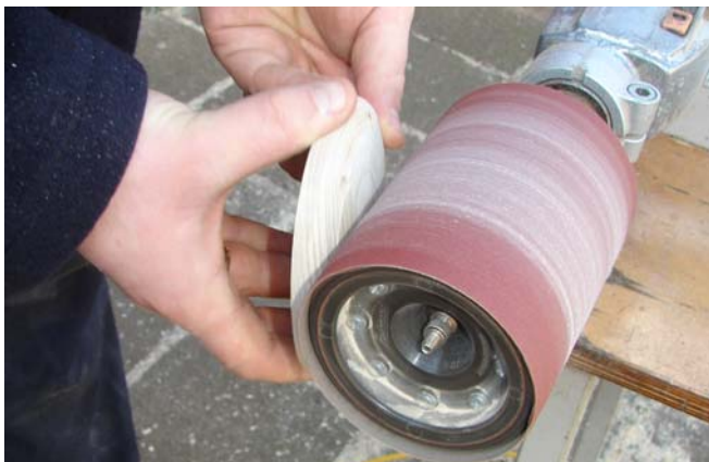
Met een oppompbare schuurrol K80 wordt het glad en bol en in de definitieve vorm geschuurd.
