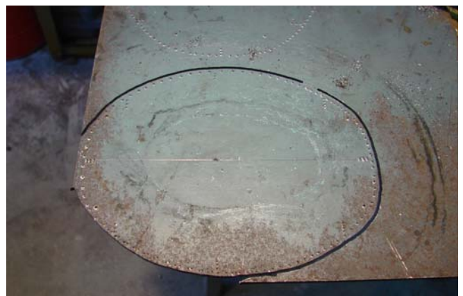
Een gedeeltelijk gezaagde boormal.
