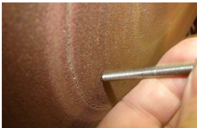
Zaagbramen verwijderen en iets schuin slijpen.
