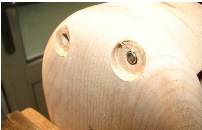
Het eind van de voeler ligt gelijk met de bodem van het potgat.
