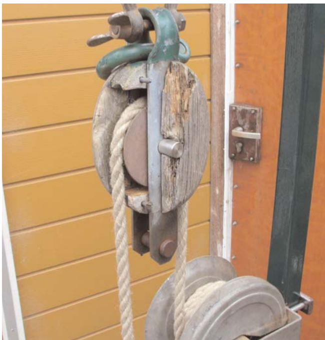
De opstelling voor het meten. Het apparaat is gemaakt van een fitness toestel voor de borstspieren. De gewichten zijn 5 kg terwijl de grijze beugel ook 5 kg weegt. Daardoor is de last per 5 kg te verstellen en aan te passen aan het blok.
