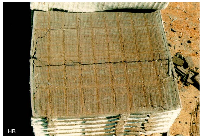
Overladen positieve plaat - wordt zeer hard
