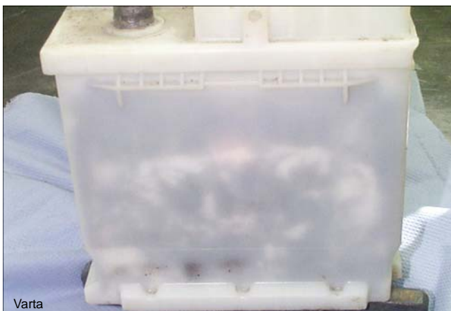
De witte sulfaatkristallen zijn door het polypropyleen te zien
