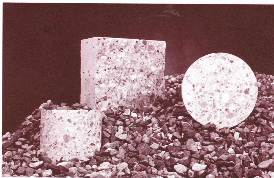
Menggranulaat en granulaatbeton, gemaakt van gerecycled beton. Het overgrote deel van het bouw- en sloopafval dat momenteel wordt verwerkt komt niet boven materiaalrecycling uit. (Foto Heembeton)
