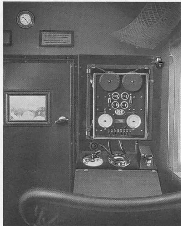
Abb. 8. Flugzeugempfänger mit Bedienungsanordnung, eingebaut in der Passagierkabine einer »Junkers G 24«, 1926
