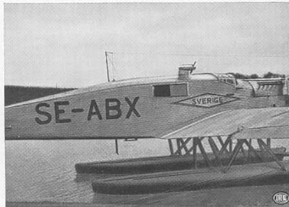
Abb. 20. Junkers-Flugzeug W 33 »Sverige« mit Propellergenerator und Dipol-Antenne, 1929
