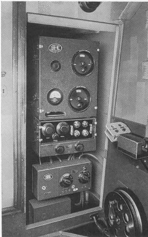
Abb. 13. 100 Watt Flugzeugfunkanlage, eingebaut in der Passagierkabine einer »Rohrbach-Roland«, 1928
