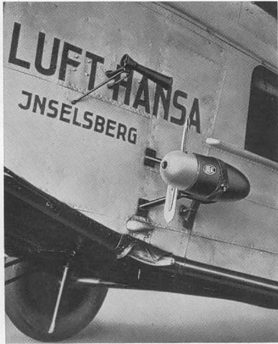
Abb. 14. Propellergenerator an einer »Rohrbach-Roland«, 1928
