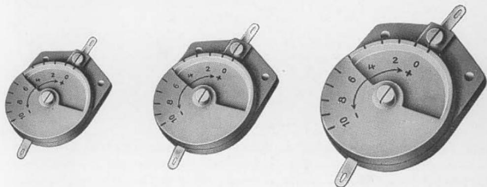
Mit dem Namen „Temperaturgang-Regler“ bezeichnen wir ein von uns entwickeltes neuartiges Schaltelement zur Temperaturkompensation, das die gegenläufigen Temperaturkennwerte unserer keramischen Sondermassen Calit (TK:  $+140 \cdot 10^{-6}$ ) und Condensa (TK:  $-720 \cdot 10^{-6}$ ) ausnutzt.
