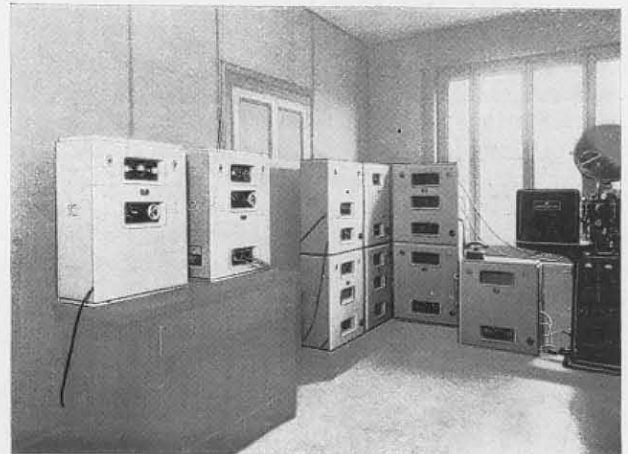
Abb. 9: Filmgeber mit Verstärkeranlage.
