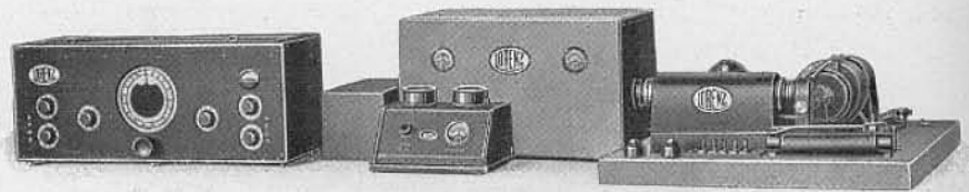
Abb. 9. Gesamtansicht des Empfangsgeräts.
